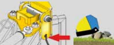
Togliendo il perno di sicurezza, permette alla trincia argini di seguire l'andamento del terreno.
