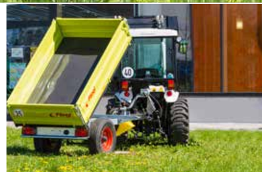
Egytengelyes három oldalra billenő pótkocsi, minden vontatómagasságra passzol
