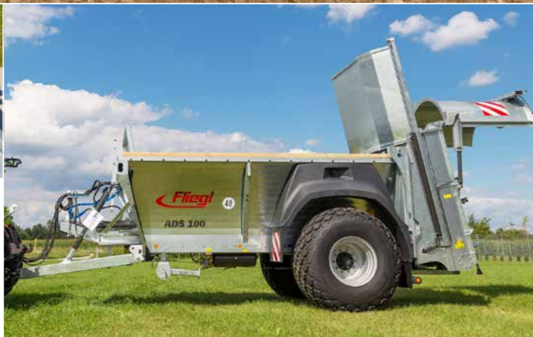
A hidraulikus letolórendszernek köszönhetően kisebb kopás - nem láncos lehordó
