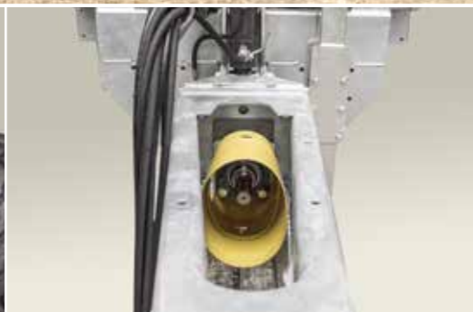
Kardánhajtás az adapterek meghajtásához
