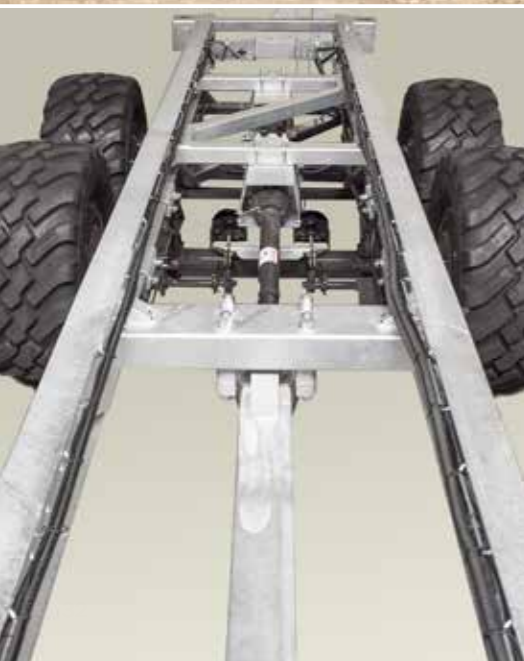
Kardánhajtás az adapterek meghajtásához
