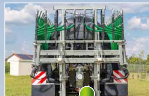
Különösen kompakt szállítási méretek 2.600 mm alul, felül 2.300 mm
