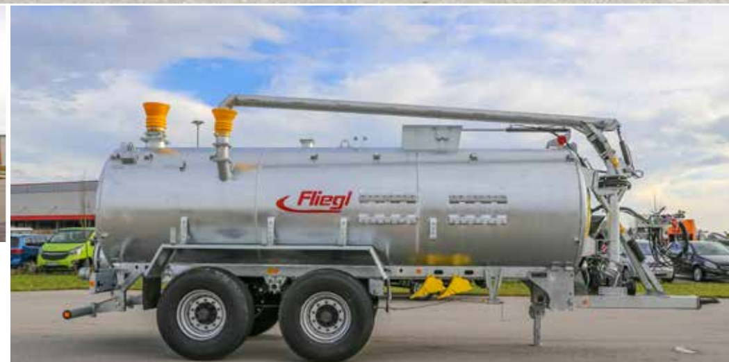
HFW 16.000 centrifugál szivattyús tandem tartálykocsi két oldalra kiterő áttöltő ormánnyal
