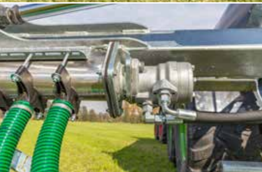
Hidromotor a csigás elosztóhoz kevés kopással és hosszú élettartammal. (szükséges olajmennyiség max. 20l)
