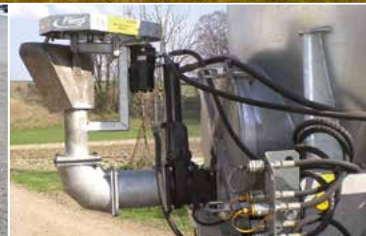
Hidraulikus csóváló terítő 12 - 18 méteres munkaszélességgel
