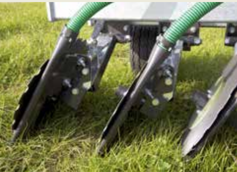
Tárcsák függőleges helyzete fokozat nélkül állítható
