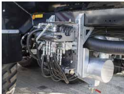
Vezérlőblokk Load Sensing-gel vagy konstans áramlású hidraulika
