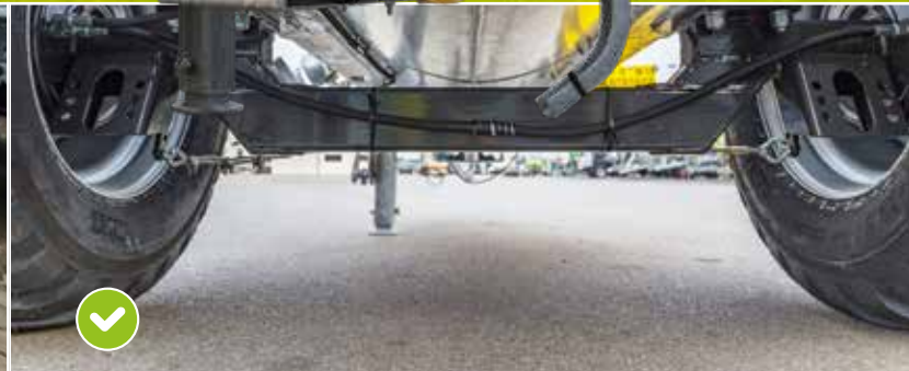
5.000 litertől hajlított tengellyel: alacsony súlypont az emelkedőn/lejtőn való jobb menettulajdonságért
