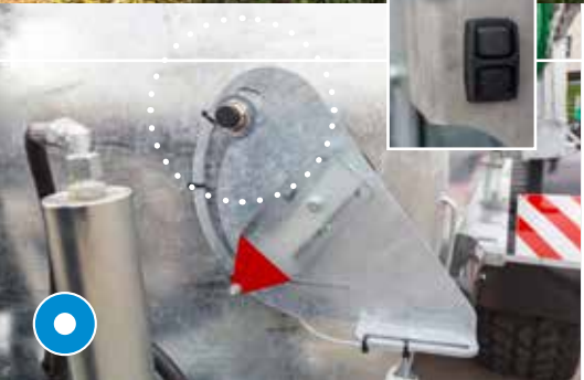
Szenzor az automatikus pumpa lekapcsoláshoz
