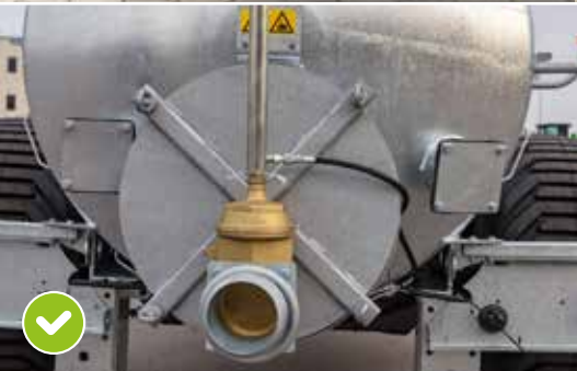
Lezáró fedelek hátul és előkészítés a lejtőn lefelé történő ürítéshez
