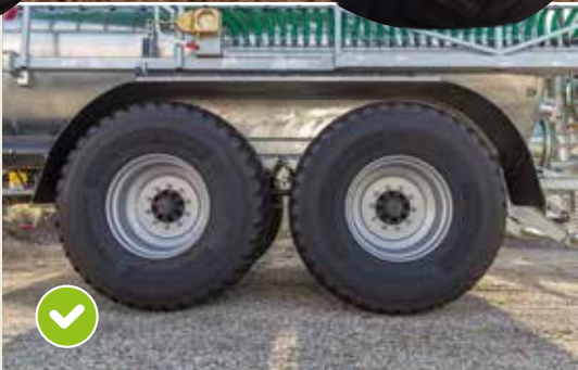
Kerékkivágás és abroncsozás Gumiabroncs 750/60-R30,5" Opció: gumiabroncs 750/60-R30,5" hátul 850/50-R30,5 elől
