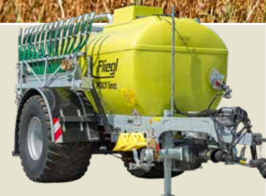
PFW 9000 Skate 90 csúszócsoroszlás terítőegységgel
