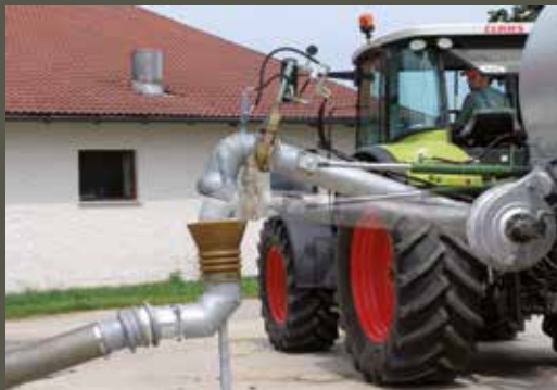
Szívóormány (opcionálisan 8" -os turbótöltővel) Bal vagy jobb oldalon lehetséges dokkoló állomással; nyomásmentesítő szelep hidraulikus kompresszorátkapcsolás
