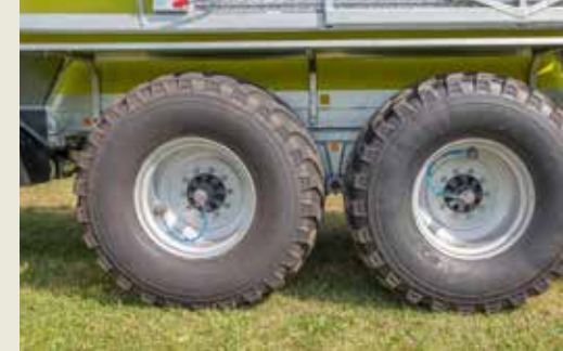
Guminyomás-szabályozó a talajkímélő terepi használatra egy- vagy kétvezetékes kivitelben
