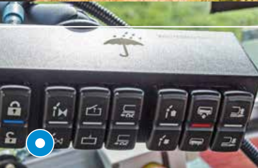
Kezelőpult a tartálykocsi és a terítőegység irányításához Ábra: piros jelzőfény a pumpa meg-védésére üresjárat esetén
