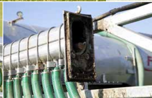
Csigás elosztó kőgyűjtőjének ürítése.
