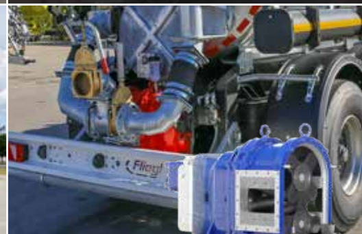
és pumpás kivitelben Vogelsang forgódugattyús szivattyúval
