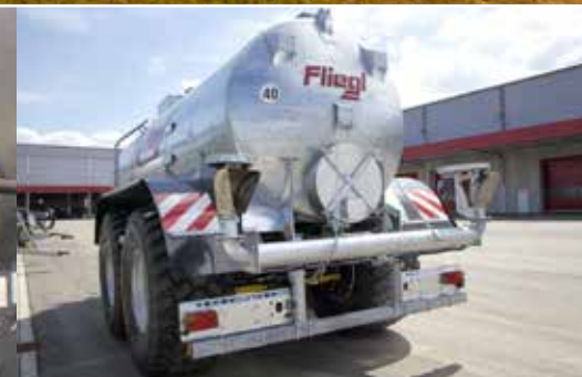
Kettős hidraulikus csóváló terítő
