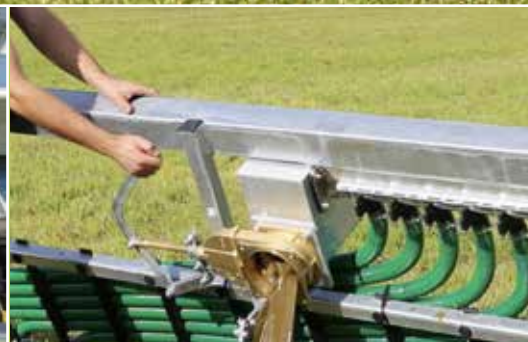
Tároló idegen testeknek (SKATE és GARANT esetén) mechanikus vagy hidraulikus ürítés
