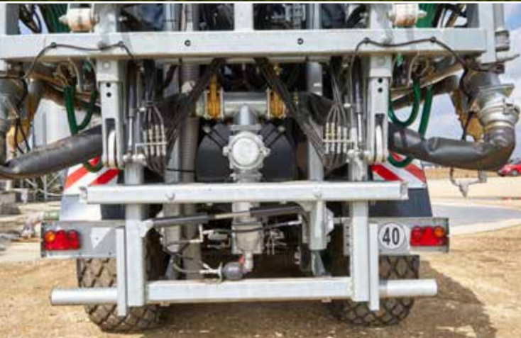
Fliegl SKATE 210 hidraulikusan szintezett keret a kifogástalan szintkiegyenlítés érdekében (csak SKATE 210/240-nél)
