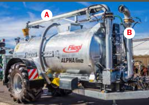
A: Felső szívóormány 4.500mm hosszú, két oldalra billenthető B: Középső szívóormány Jobb és bal oldali felszívás is beállítható
