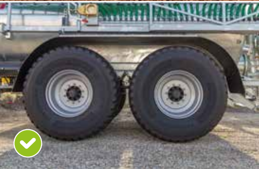
Kerék kivágás és abroncsozás Gumiabroncs 750/60-R30,5" Opció: Gumiabroncs 750/60-R30,5" hátul 850/50-R30,5 elől
