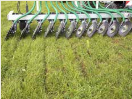
A tárcsák kijuttatás iránnyal bezárt szöge is állítható
