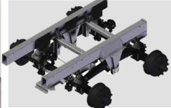
Titan tandem rugózás szerkezet a legjobb kiegyenlítésért
