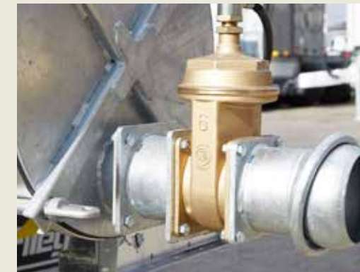
Hidraulikus harang tolózárr, amely robusztus és maradványokra nem érzékeny (szalmás hígtrágya esetén ideális)
