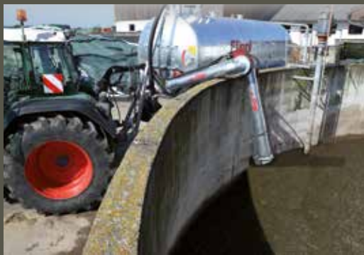
Szívóormány Elefant 8"-os Bal vagy jobb oldalon lehetséges 5.000 mm-es hosszúság négy tagos vezérlőtömbbel Opcionálisan 1.500 mm-es teleszkóp hosszabbítóval
