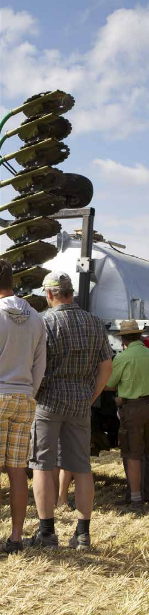
Szívóormány Elefant 8"-os Bal vagy jobb oldalon lehetséges 5.000 mm-es hosszúság négy tagos vezérlőtömbbel Opcionálisan 1.500 mm-es teleszkóp hosszabbítóval
