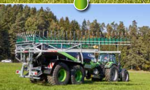
A tömlő törésmentes vezetése a speciális mechanizmus által
