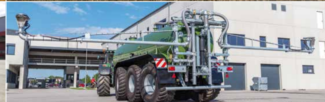
Csőkeretes kijuttató 21-30 m maximális munkaszélességgel
