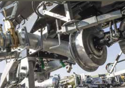
Turbótöltő középen a tartály alatt Szívónyílás jobb vagy bal oldalon lehetséges
