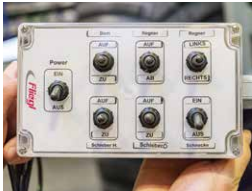
Kezelőpult a tartály irányításához Skate terítőegység nélkül, 6 funkcióig
