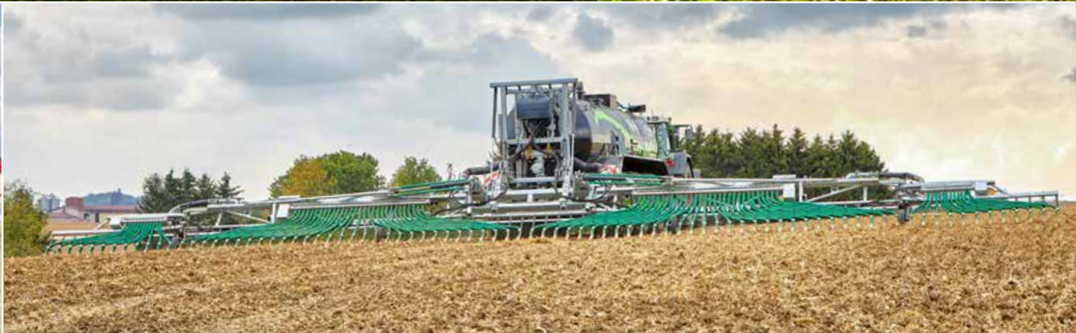
Fliegl SKATE 210 hidraulikusan szintezett keret a kifogástalan szintkiegyenlítés érdekében (csak SKATE 210/240-nél)
