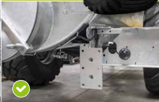
Tartókonzol az injektáló vagy csúszócsoroszlyás terítőegység számára 5.000 litertől
