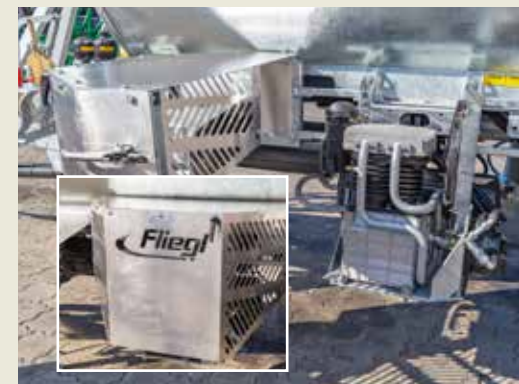
Dugattyús kompresszor 3,3 m³ teljesítménnyel
