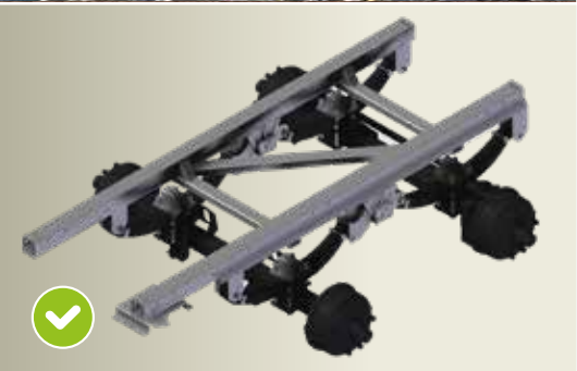
»Gigant« futómű MAXX Line Plus 14.000 l esetében
