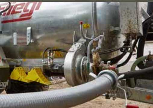
Turbótöltő gyorscsatolóval (6" vagy 8") Bal, jobb oldalon vagy hátul lehetséges
