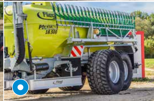
PolyLine sokféle kiviteli változatban, pl. teleszkópos tengellyel kapható • Megoszló talajtaposás • Nagyon jó stabilitás lejtőn
