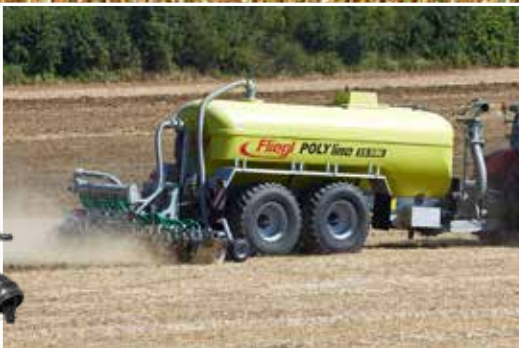
PFW 15.500 tárcsás terítőegységgel Maulwurf 6 m
