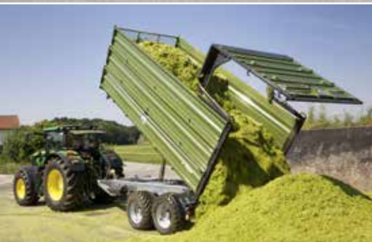
Silószállításához billentős pótkocsi hidraulikus hátfallal
